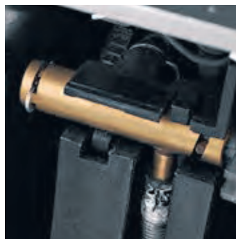
Nahrungsmittel- und Getränkeindustrie: Wasserzulauf in einem Kaffeeautomaten
